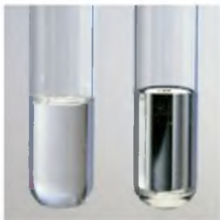
▲ Figura 11.16 Dos formas de meniscos. El menisco del agua en un tubo de vidrio comparado con el menisco del mercurio en un tubo similar. El agua moja el vidrio, y el fondo del menisco se encuentra por debajo del nivel de la línea de contacto agua-vidrio, lo que da una forma de U a la superficie del agua. El mercurio no moja el vidrio, y el menisco se encuentra por arriba de la línea de contacto mercurio-vidrio, lo que da una forma de U invertida a la superficie de mercurio.
